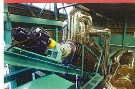
溶けた原料は、ガス分解部で気化され、傾斜管の上部へと送られていきます。上部から下部への温度差による「逆熱勾配」を生み出すことにより、原料はそれぞれ、その種類に応じた温度帯のところで1次分解を起こしガス化します。さらに傾斜管は、上部へ上がっていくほど温度が高いことから、気化したガスはその材料の特性により、自然と2次分解を起こすこととなるわけです。
