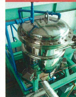
ガス分解部 (逆熱勾配傾斜管)
